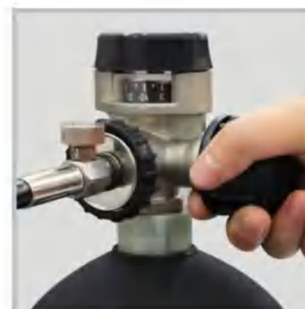
4、打开储气瓶瓶阀,向被补气气瓶供气
