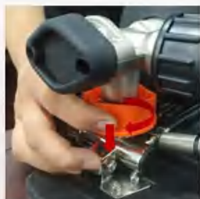
5.气瓶拆卸,一只手托住气瓶,一只手将气瓶快换桔黄色手轮顺时针旋转并且同时用力往下按压
