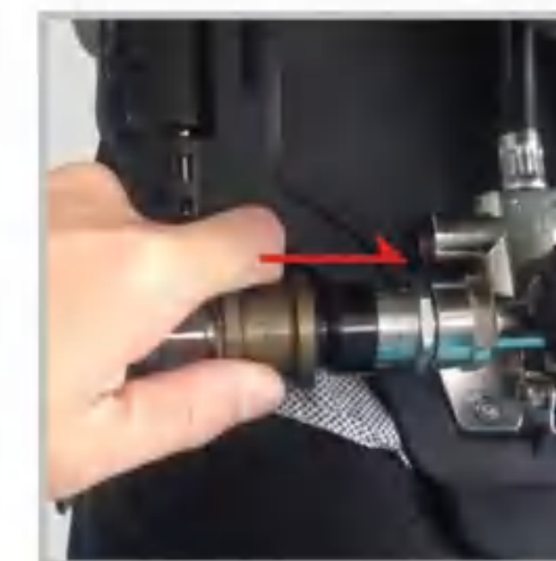
3、充气管另一端高压母接头与减压器上快速充气装置输入端快速接,听到“嗒”的声音说明对接完成
