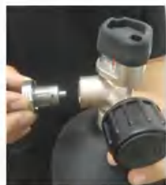
1.将气瓶快换母接头与气瓶瓶阀对准
