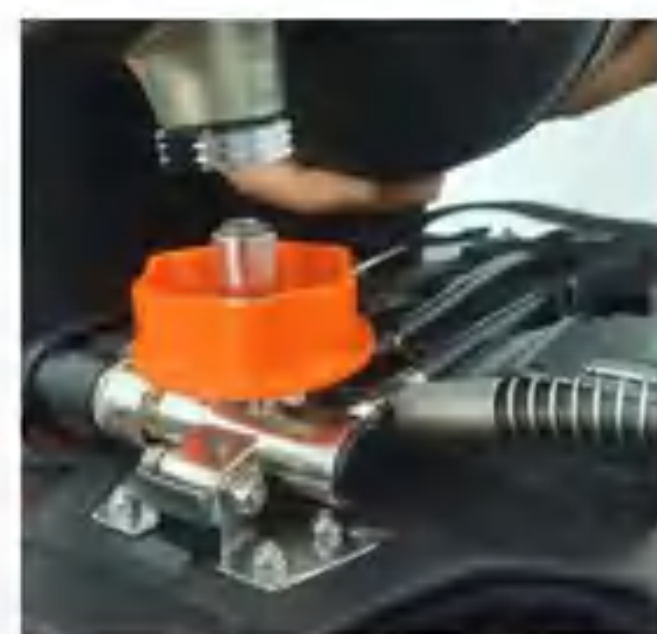
3.将气瓶快换母接头与减压器上气瓶快换公接头对准
